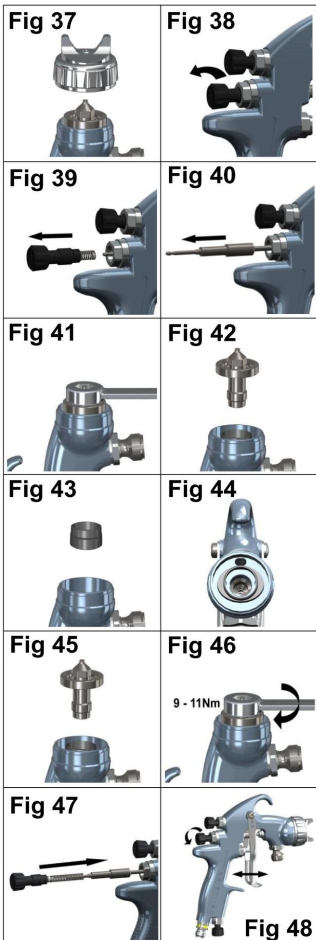
1. Retire el cabezal de aire y el anillo de retención. (Ver Fig. 37)
