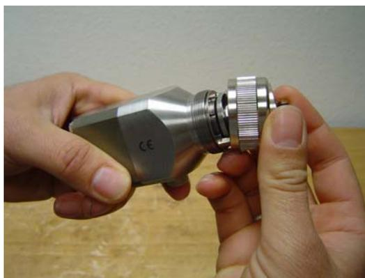
2. Dévisser la buse (n° 3) à l'aide de la clé à douille 1/2" puis la démonter.
