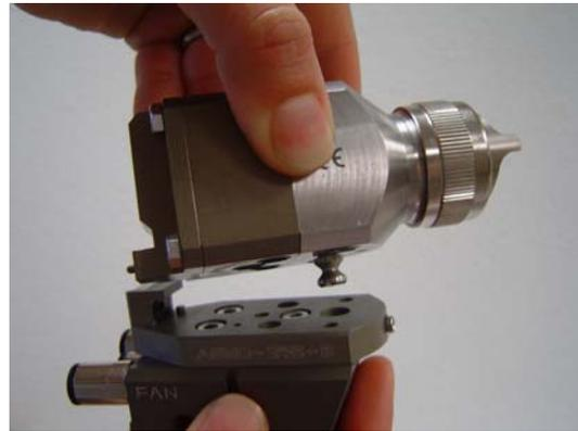
3. Introduire le verrouillage conique dans le logement.
