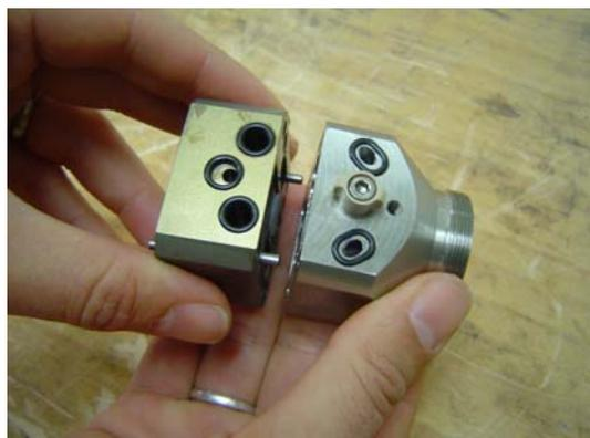
9. Graisser la pointe de l'aiguille de peinture (n° 10) et l'insérer dans le piston (n° 14).
