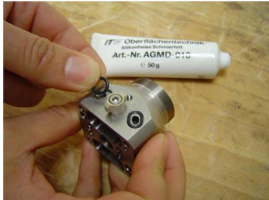
6. Graisser les joints toriques (n° 11) puis les positionner dans les rainures du porte-tête (n° 13).
