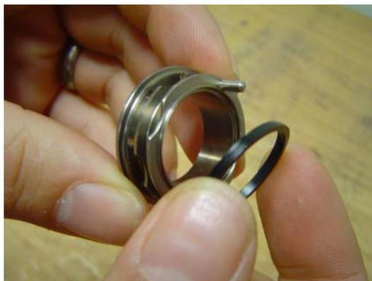
18. Positionner l'anneau du répartiteur d'air avec la bague d'étanchéité inférieure dans la tête.
