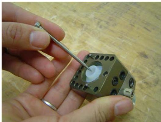
10. Positionner le boulon à ressort (n° 15) dans le piston.
