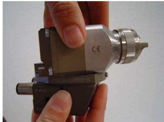
4. Tourner le pistolet automatique AGMD à haut rendement de 45° dans le sens des aiguilles d'une montre jusqu'à ce qu'il s'enclenche dans le verrouillage arrière.
