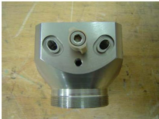
Si le pistolet automatique AGMD à haut rendement est vissé ultérieurement sur la plaque intermédiaire, il est également possible de masquer la vis de centrage (n° 7.1) pour le verrouillage (n° 7 avec 8).
