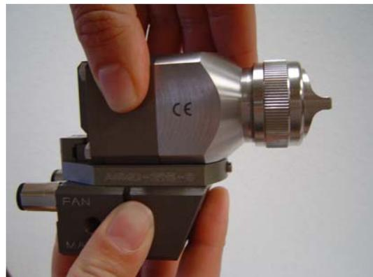
5. Fixer le pistolet automatique AGMD à haut rendement et la « tige filetée munie d'une pointe » sur la plaque intermédiaire avec une clé Allen 3.
