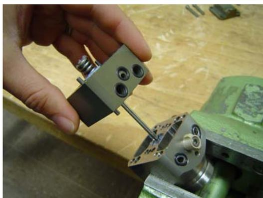
7. Retirer les deux ressorts (n° 16 et 17), le boulon à ressort (n° 15) et l'aiguille de peinture (n° 10).
