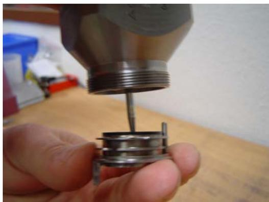
19. Positionner la bague d'étanchéité supérieure (n° 4) dans l'anneau du répartiteur d'air.
