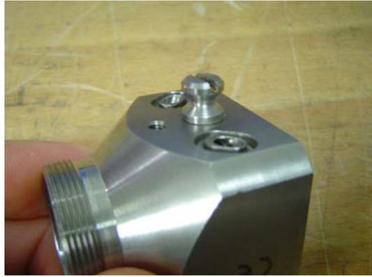
5. Graisser deux joints toriques (n° 12) puis les positionner dans les rainures de la tête (n° 6).
