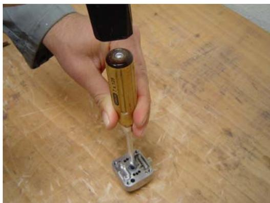
10. Dévisser la vis (n° 8) avec une clé Allen 6 et retirer le verrouillage (n° 7).
