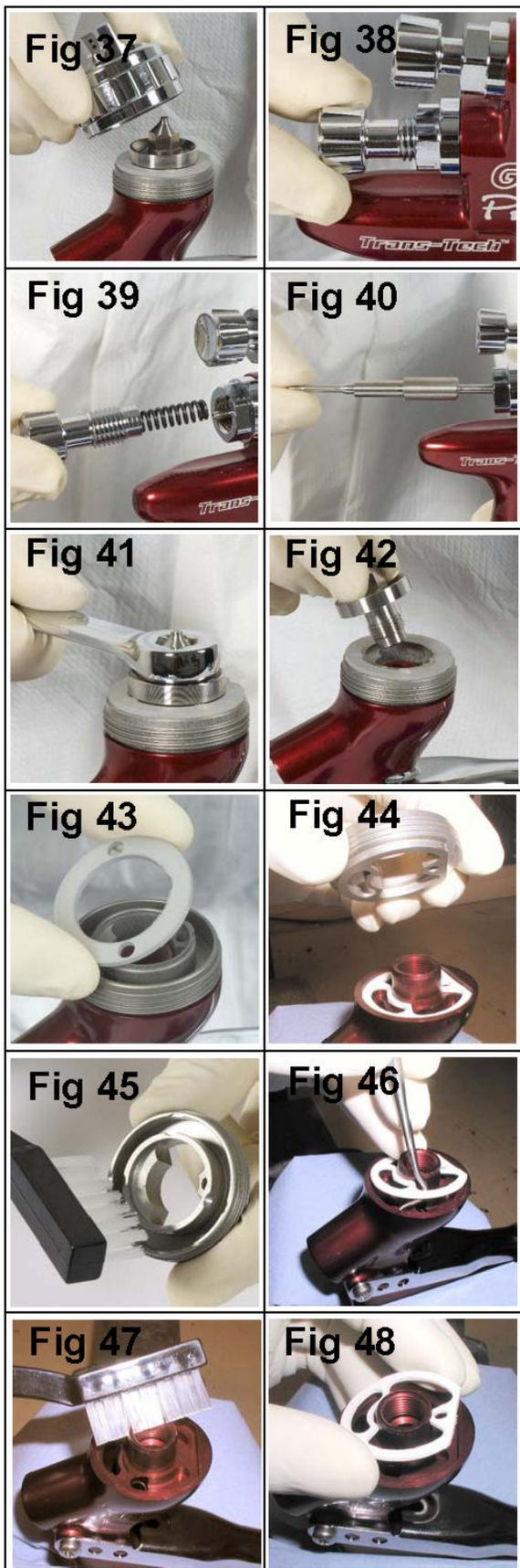
1. Déposer le chapeau d'air et la bague de retenue (voir fig. 37)
