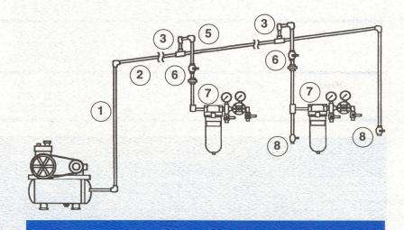
La inclinación de la línea debe ser hacia arriba y de por lo menos 4 pulgadas cada 50 pies. Esta inclinación de la tubería ayuda a dirigir los contaminantes (condensación de agua y polvo del interior de la tubería) hacia el compresor el cual debe drenarse diariamente.
