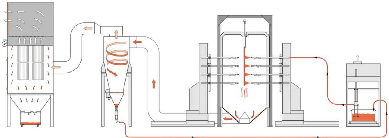
**La pintura en polvo se fluidiza directamente en el contenedor. Los inyectores controlados por una sonda de nivel transportan la pintura en polvo hasta las pistolas, a través de dos juegos de mangueras, unas para colores claros y otras para colores oscuros.**
