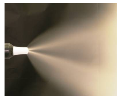
volumen excesivo de aire de limpieza del electrodo
