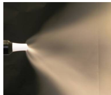
aire total insuficiente
