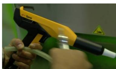
10. Retirar el pulverizador, limpiarlo y limpiar la pistola con aire comprimido
