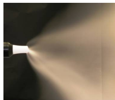
aire total insuficiente
