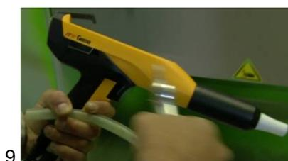
10. Retirar el pulverizador, limpiarlo y limpiar la pistola con aire comprimido
