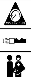
**Peligro de inyección de fluido y alta presión:** por la pulverización o las filtraciones a alta presión se pueden inyectar fluidos en el organismo.
