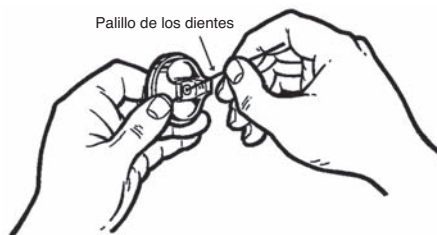
Figura 20 - Limpieza de la válvula de aire
